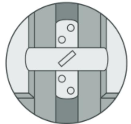
**S 20**, Knebel aus Zinkdruckguß, für einflügelige Fenster und Türen für 17 mm Überschlaghöhe, weiß oder braun, mit Sicherungsschlüssel zum Betätigen, 4 Befestigungsschrauben 5 x 50 mm, 2 Ausgleichplatten 85 x 22 x 1 mm und 85 x 22 x 2 mm
